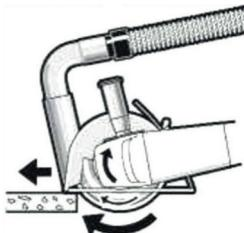
Заметное снижение производительности работы и венец из искр по кругу свидетельствуют о затуплении алмазного отрезного круга. Алмазный отрезной круг можно заточить короткими резами в абразивном материале (напр., в силикатном кирпиче).
