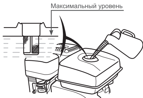
Рис. 6. Максимальный уровень топлива в топливном баке
