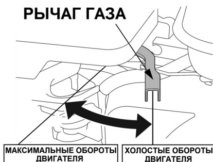
Рис. 9. Положения рычага газа
