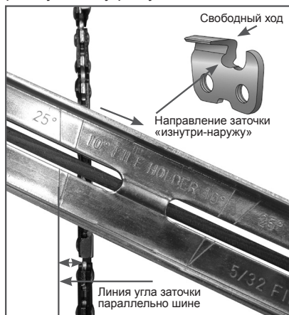
Рис. 18 Определение угла заточки
