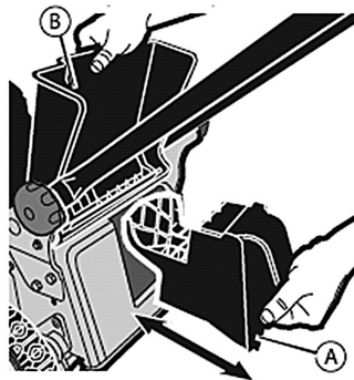
Рис. 15 Установка заглушки для мульчирования
