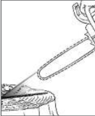
Рис. 7 Проверка смазки шины и цепи
