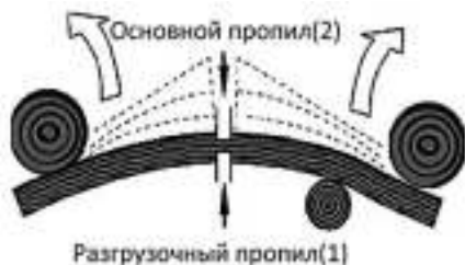
Рис. 13 Распиливание дерева, когда оба конца дерева зажаты и находятся под напряжением
