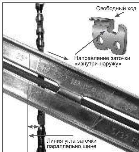
Рис. 16 Определение угла заточки
