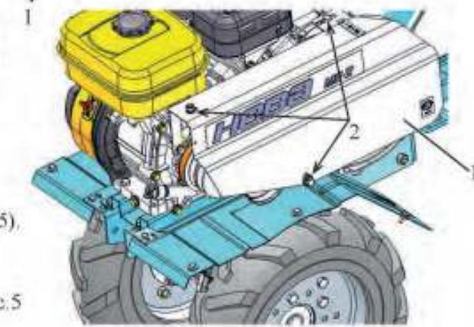
Снять защитный кожух (1), открутив три болта (2) (рис.5).
