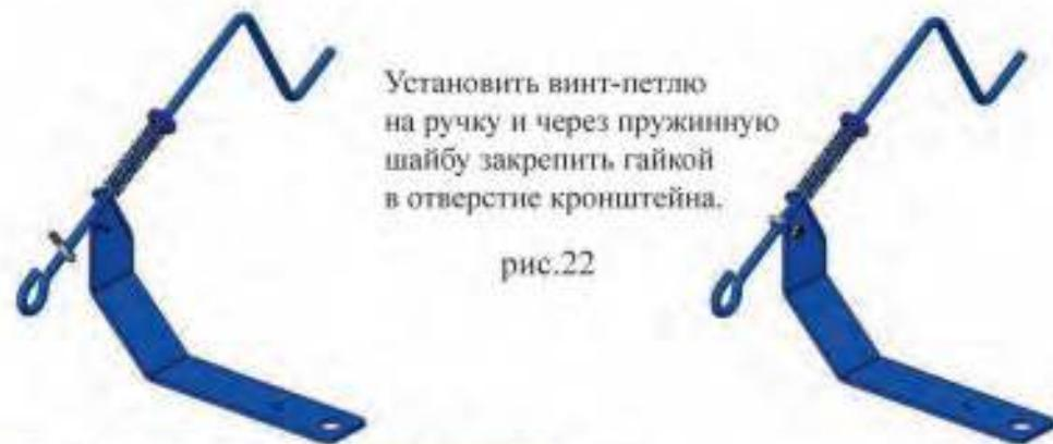
Установить винт-петлю на ручку и через пружинную шайбу закрепить гайкой в отверстие кронштейна.
