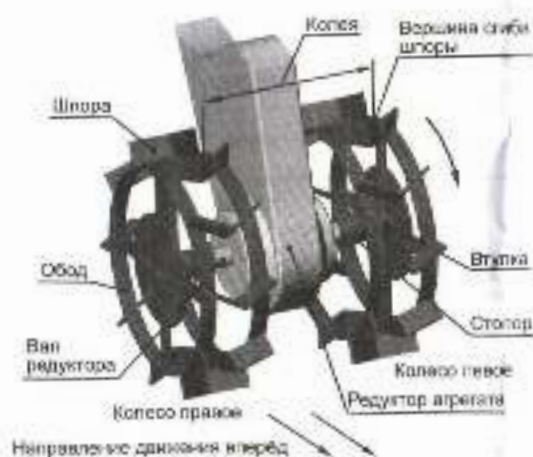
Установка на вал редуктора через удлинитель (для увеличения колес)
