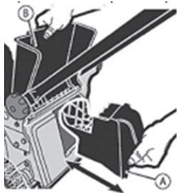
Рис. 5 Установка заглушки для мульчирования
