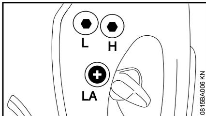
Карбюратор агрегата отрегулирован на заводе таким образом, чтобы двигатель во всех режимах работы получал оптимальную топливовоздушную смесь.
