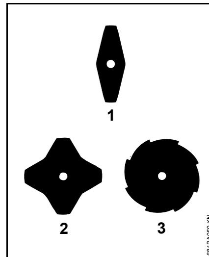
На режущих дисках для травы (1) и (2) режущие кромки могут быть направлены в любую сторону – этот режущий инструмент регулярно поворачивать, чтобы избежать одностороннего износа.
