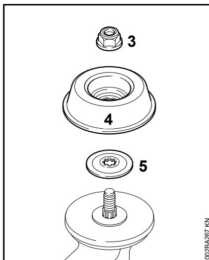
Для крепления некоторых косильных головок и режущих дисков для травы дополнительно требуются гайка (3), рабочий диск (4) и нажимная шайба (5).
