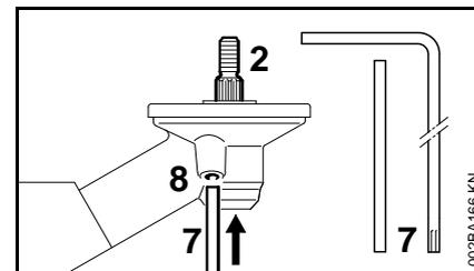
Для монтажа и демонтажа режущих инструментов вал (2) должен блокироваться с помощью стержня (7) либо изогнутой отвёртки (7). Комплектующие в некоторых случаях входят в объём поставки, а также поставляются в качестве специальных принадлежностей.
