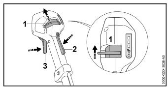
Большим пальцем перевести фиксирующий рычаг (1) в положение ஓ.
