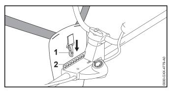
Вставить перфорированную пластину (2) в карабинную застежку (1).
