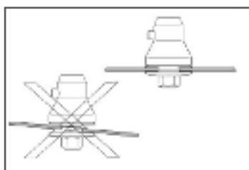
**УВАГА!** При установці ріжучого обладнання, важливо, щоб напрямна повідкового патрона/опорного фланця була посередині отвору ріжучого обладнання. Неправильно встановлене ріжуче обладнання може стати причиною серйозної травми.
