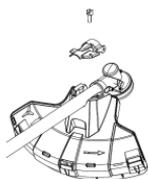
Наденьте защитный кожух на штангу и зафиксируйте его тремя болтами. Используйте рекомендованный защитный кожух (см. раздел «Технические характеристики»).
