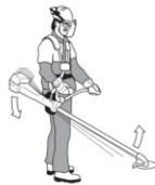
Отрегулируйте наплечный ремень таким образом, чтобы режущий инструмент располагался параллельно земле. Положите триммер, чтоб режущий инструмент слегка касался земли и отрегулируйте положение подвесного кольца до достижения правильной развесовки.
