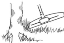
Расположите триммерную катушку непосредственно над землей и наклоните ее. Конец лески может ударяться о землю вокруг объектов. **ВНИМАНИЕ!** При выполнении данной операции увеличивается износ лески.
