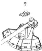
Дополнительный защитный кожух необходимо устанавливать при использовании триммерной катушки. Этот дополнительный кожух необходимо всегда снимать при использовании ножей для травы.
