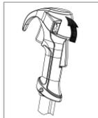
а). **Включите зажигание:** переведите выключатель зажигания в положение "I".
