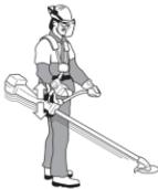
Хорошо отрегулированный ремень значительно упрощает работу с триммером. Отрегулируйте его таким образом, чтобы перемещение триммера было максимально удобным. Натяните боковые лямки таким образом, чтобы вес равномерно распределялся по обоим плечам.
