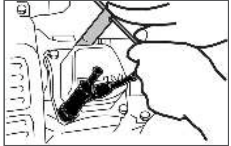
Рис. 15 Обслуживание свечи зажигания
