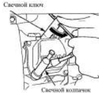
Рис.18 Обслуживание свечи зажигания
