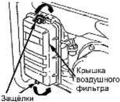
Рис. 14 Снятие крышки воздушного фильтра
