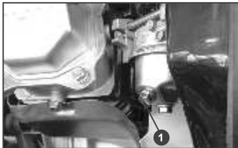
Рис. 20 Слив топлива из карбюратора 1. Болт сливной
