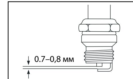
Зазор между электродами должен составлять 0,7–0,8 мм.
