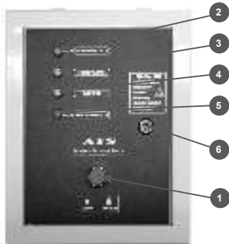
Рис. 13 Контрольная панель блока ATS
