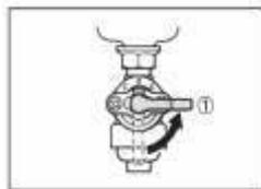
5. Закройте топливный кран, если двигатель будет помещен в место хранения или будет перевозиться.
