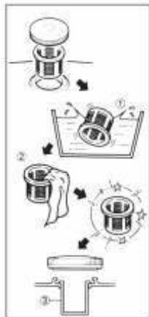
1. Снимите пластмассовый фильтр бензобака, расположенный под крышкой горловины бензобака.
