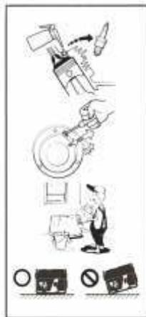
4. Снимите свечу зажигания и залейте в через образовавшееся отверстие 1 чайную ложку масла, несколько раз дерните шнур стартера при выключенном двигателе и установите свечу обратно. Затем потяните стартер, пока поршень не войдет в такт сжатия, и оставьте его в таком положении. Это способствует закрытию входного и выпускного клапанов, что необходимо для предотвращения коррозии цилиндра.
