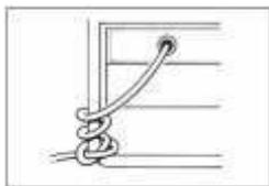
2. Кабель питания оберните 2-3 раза вокруг трубы рамы генератора.
