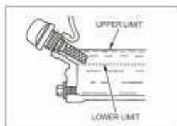
Залейте масло в двигатель в соответствии с инструкциями. Если генератор поставляется со щупом для измерения уровня масла, масло доливается до соответствующего уровня. Если щупа нет, масло доливается до отверстия маслозаливной горловины. Не наливайте масло в избытке. Не вдавливайте щуп в маслозаливную горловину для проверки уровня масла.
