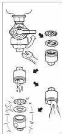
1. Снимите фильтр топливного крана.
