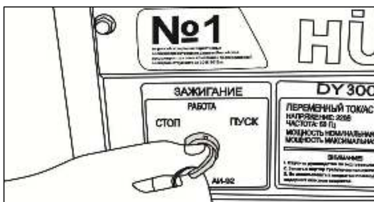
Рис. 17. Запуск двигателя электростартером
