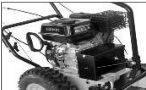
Рис. 3 Установка рычага поворота щетки
