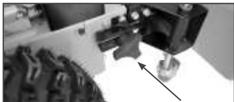
Рис. 7 Отсоединение щетки от корпуса машины
