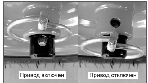
Рис. 17 Перестановка шплинта на левом колесе
