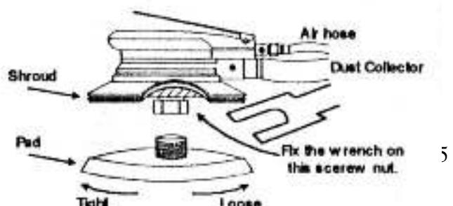
Если шлифовальная подставка потеряла свои свойства, то ее необходимо заменить на новую. Для того, чтобы заменить подставку поверните защитный кожух и вставьте ключ, чтобы закрепить болт в центре, затем, поверните шлифовальную подставку как показано на рисунке справа.
