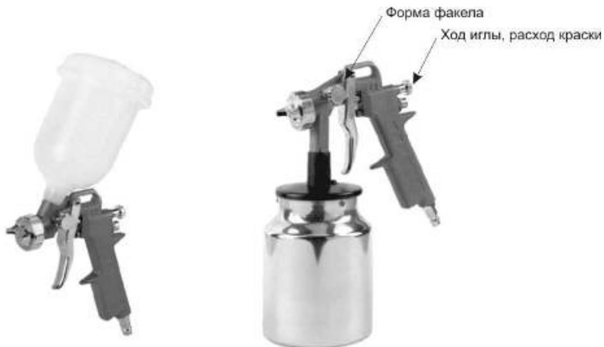
Рис. 4 Регулировки краскораспылителя
