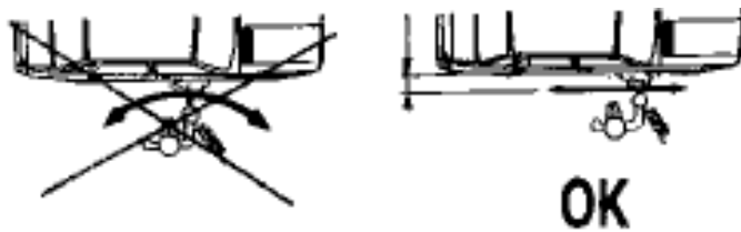
Рис.1 Положение оператора и направление движения краскопультотом
