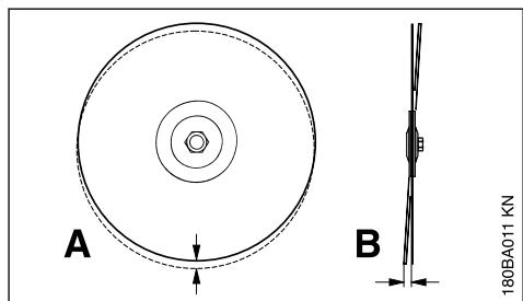
Чрезмерное отклонение от допуска на радиальное биение (A) перегружает отдельные алмазные сегменты, которые, при этом, нагреваются. Это может вызывать возникновение трещин в основном полотне или расплавление отдельных сегментов.
