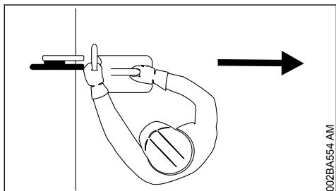
Следить за тем, чтобы в расширенный диапазон поворота абразивно-отрезного круга не
