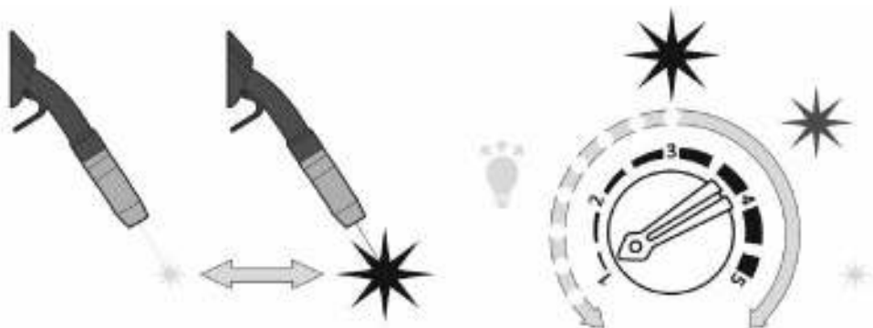
Рис. 10.2. Выбор чувствительности датчиков.
