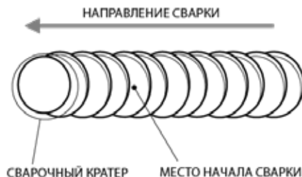
Рис. 11.2.2. Начало сварки при смене электрода.
