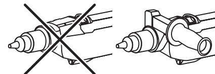
Работа без установленной дополнительной рукоятки ЗАПРЕЩАЕТСЯ
