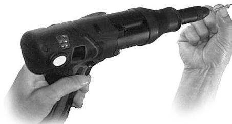
3. Переключите кнопку реверса в режим правого вращения и нажмите «**пуск**». Удерживайте кнопку до характерного щелчка, означающего установку заклепки и отрезания «**хвоста**».
