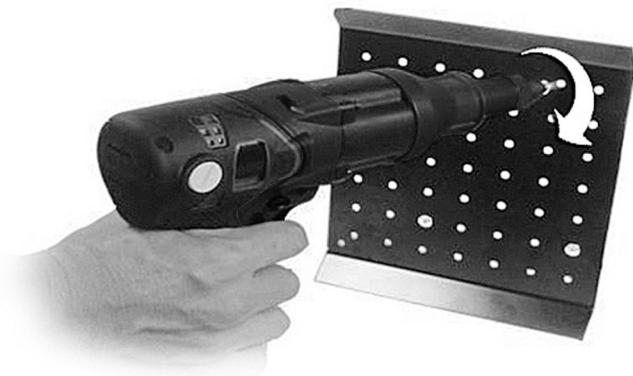
6. После установки заклепки переключите реверс в режим левого вращения и нажмите «**пуск**» для «**выброса**» из инструмента хвостовой части заклепки в контейнер. Убедитесь, что это произошло.
