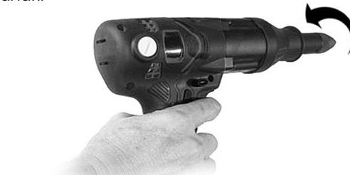
2. Установите заклепку в насадку (Хвостовик заклепки должен свободно входить в отверстие насадки) и вставьте ее в отверстие скрепляемых материалов.
