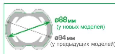
Диаметр сердечника статора уменьшен на 6 мм<sup>\*2</sup>
