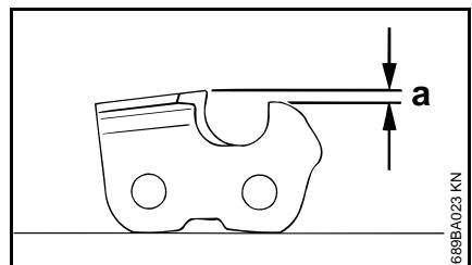
Ограничитель глубины определяет глубину врезания в древесину, т.е. толщину стружки.
