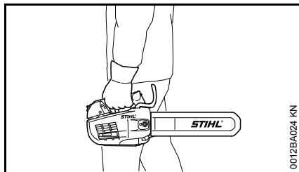
Переносить бензопилу, держа только за рукоятку управления, не прижимать к телу горячий глушитель, направляющая шина должна быть направлена назад. Не дотрагиваться до горячих деталей агрегата, в особенности до поверхности глушителя – опасность ожога!
