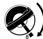
Правильно установить крышку бака с откидным хомутиком (байонетный затвор), повернуть до упора и захлопнуть хомутик.
