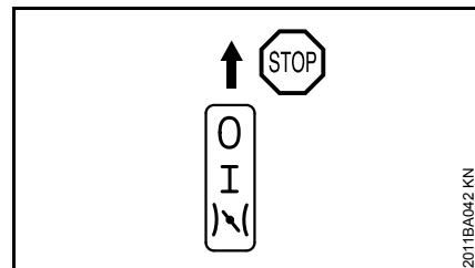
**STOP-0** – двигатель остановлен – зажигание выключено
