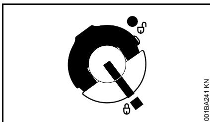
Крышка бака зафиксирована
