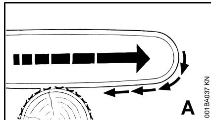
Если при пилении нижней стороной направляющей шины – передний рез – цепь защемляется или наталкивается на твердый предмет в древесине, то пила может быть затянута рывком в сторону ствола – поэтому **во избежание этого всегда надежно устанавливать зубчатый упор**.
