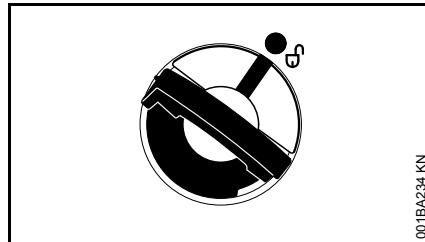
Маркировки на крышке бака и топливном баке должны друг с другом совпадать
