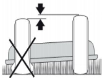
Если срез неровный, проверьте давление в шинах .
