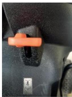
Этот рычаг останавливает движение машины, когда она припаркована. Есть две позиции:
