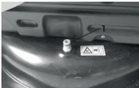
б) Для очистки верхней части косильной деки:
