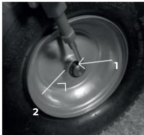
1. Установите газонокосилку на ровную поверхность и подложите блоки под несущую часть рамы со стороны колеса, подлежащего замене;
