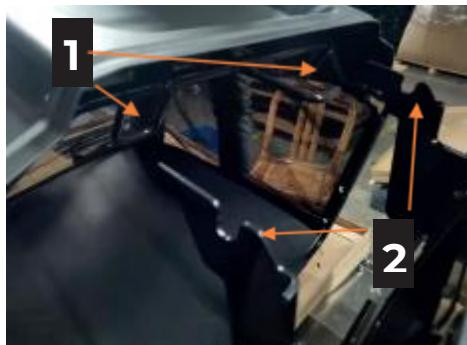
Закрепите травосборник (1) на кронштейнах (2) и выровняйте его по центру задней пластины так, чтобы две контрольные метки (3) совпали.
