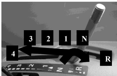
Этот рычаг имеет шесть положений для четырех передач переднего хода, нейтральное положение «N» и заднее положение «R».
