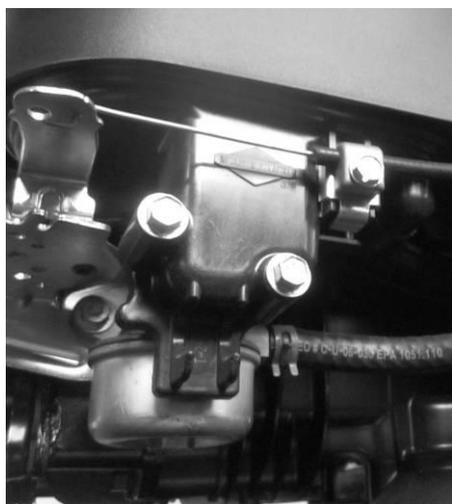
Опорожните топливный бак, открутив винт, расположенный в нижней части топливного фильтра (1), и перелейте топливо в подходящую емкость.
