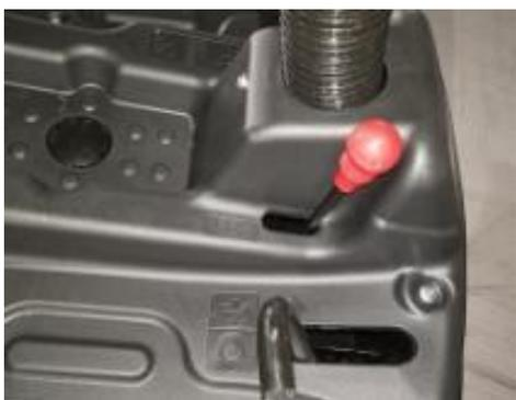
Метод эксплуатации: нажмите на тормоз, нажмите до упора, потяните рычаг Р назад, отпустите ногу с тормоза и припаркуйте косилку.
