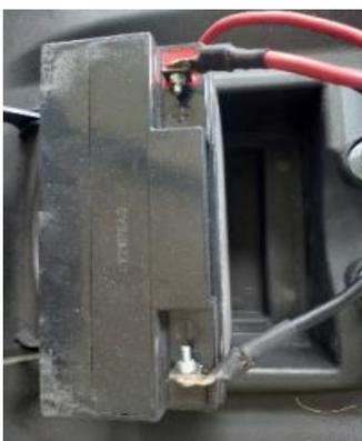
1. Установите аккумулятор вертикально в батарейный отсек под сиденьем.
