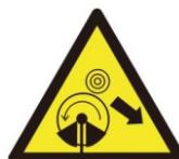
При соприкосновении лезвий с твердыми предметами может возникнуть опасность обратного удара.
