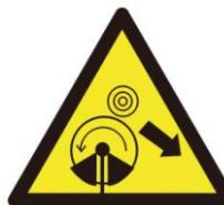
При применении металлического режущего инструмента (режущее полотно для травы, нож для молодой поросли, пильный диск) существует опасность отдачи, если инструмент натолкнется на твердые препятствия (ствол дерева, ветка, пень, камень или т.п.) При отдаче устройство отбрасывается назад – против направления вращения инструмента.
