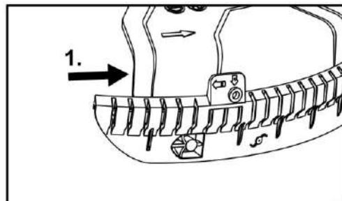
□ Вставьте нижнюю направляющую кромки в защитный кожух и убедитесь, что направляющая защелкнулась точно.
