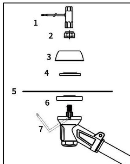
□ Установите прижимной диск (6) и зафиксируйте ее с помощью стержня или изогнутой отвертки (7). Установите диск (5), упорную шайбу (4), крышку гайки (3), гайку (2), затяните их комбинированным ключом против часовой стрелки.
