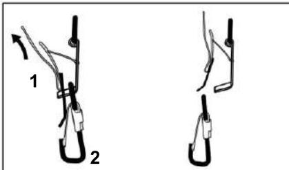
□ С помощью легко снимаемого крючка потяните за штифт (1) и крючок (2), он может быстро сниматься.
