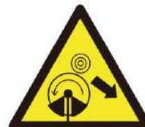
При применении металлического режущего инструмента (режущее полотно для травы, нож для молодой поросли, пильный диск) существует опасность отдачи, если инструмент натолкнется на твердые препятствия (ствол дерева, ветка, пень, камень или т.п.) При отдаче устройство отбрасывается назад – против направления вращения инструмента.
