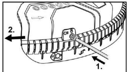
□ Вставьте инструмент в отверстие на кромке и сдвиньте его влево
