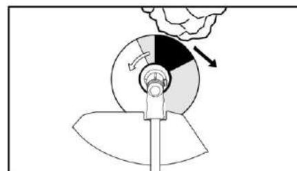
□ Повышенная опасность отдачи возникает, если инструмент наталкивается на препятствия в темном секторе.
