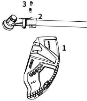
□ Совместите отверстие защитного кожуха (1) с отверстием защитной пластины (2), вставьте винт (3) внутрь отверстия и затяните его с помощью инструментов.
