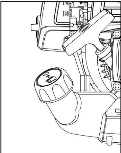
□ Перед заправкой протрите крышку топливного бака и близлежащие участки, чтобы предотвратить попадание грязи в топливный бак.
