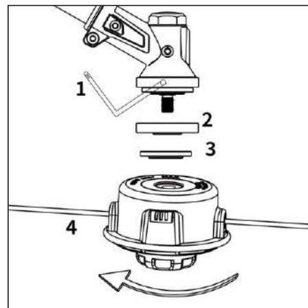
□ Установите прижимной диск (2) и опорную шайбу (3) одну за одной, затем зафиксируйте прижимной диск с помощью стержня или изогнутой отвертки (1).
