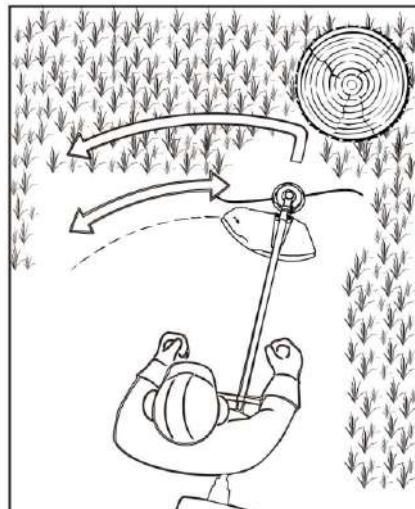
□ Косильная головка применяется, при необходимости скашивания травы возле построек и деревьев. Косильная струна не наносит ущерба обкашиваем предметам и исключается риск повреждения инструмента.
