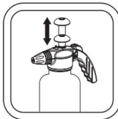
2. Затяните узел распыления, обеспечив герметичное закрытие. За ручку насоса накачайте необходимое для работы давление.
