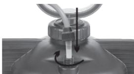
Соедините заборную трубку (21) и шланг (18). Заверните гайку (19) на штоке.
