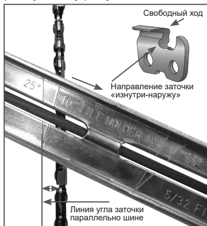
Рис. 19 Определение угла заточки
