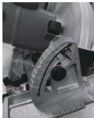
Установка угла пропила
