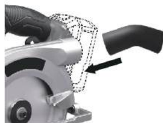
Установка пылеотводного патрубка
