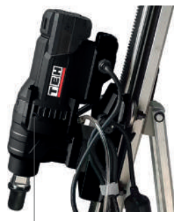
отверстие для контроля состояния сальников
