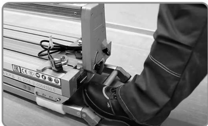
1 ) Зафиксируйте опору станка.
