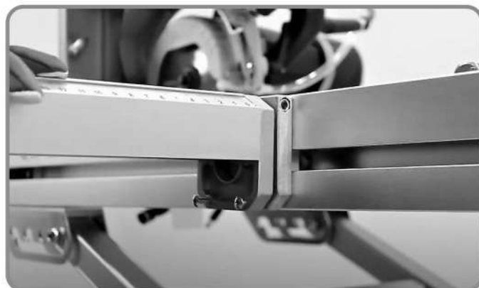
6 ) Станок оснащен выдвижными консолями с опорой, на которых расположена линейка и упор для фиксации плитки. Шкала на линейке начинается от плоскости диска. Установите универсальные упоры.
