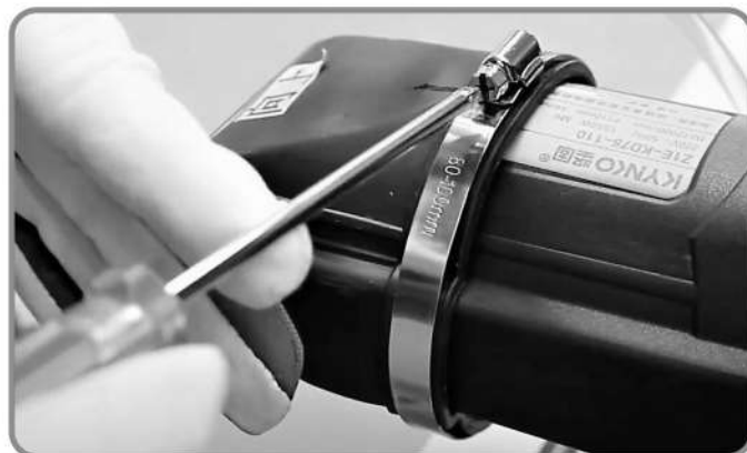
5 ) С помощью хомута идущего в комплекте, зафиксируйте кожух на задней части двигателя.
