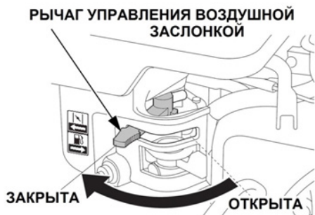
Рис. 14 Рычаг управления воздушной заслонкой
