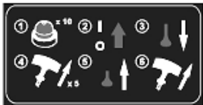
Рис. 12 Алгоритм запуска двигателя
