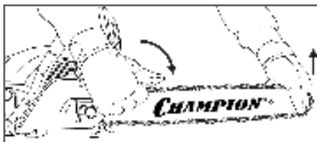
Рис. 4 Затяжка гаек крепления крышки шины
