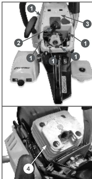
Рис. 23 Очистка охлаждающих ребер цилиндра
