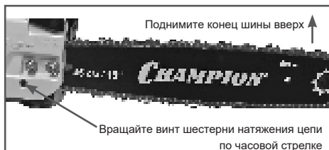
Рис. 5 Регулировка натяжения цепи
