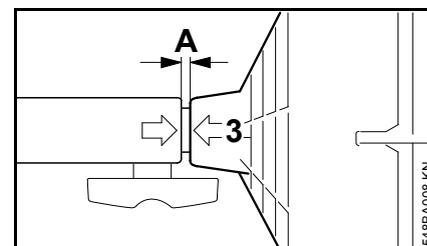
При правильной установке защитная решётка (3) должна соединяться с муфтой сцепления (зазор А максимум 5 мм).
