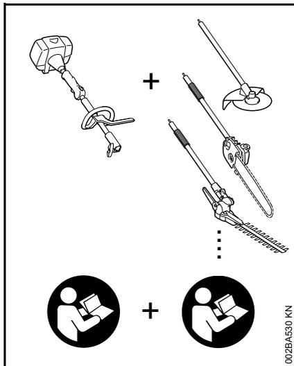
Комбинированная система STIHL объединяет в одном мотоустройстве различные комбинированные двигатели и комбиинструменты. Работоспособная конструктивная единица состоящая из комбинированного двигателя и комбиинструмента называется в данной инструкции по эксплуатации мотоустройством.
