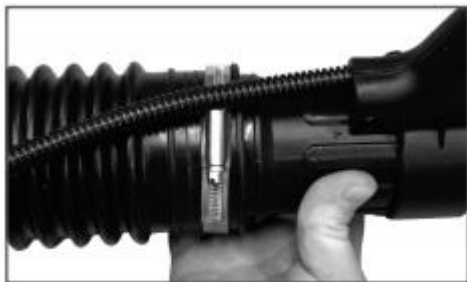
Рис. 5 Установка трубы напорной «А»
