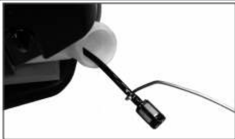
Рис. 15 Извлечение топливного фильтра
