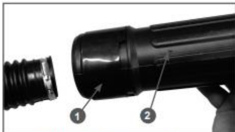
Рис. 3 Труба напорная «А» 1. Втулка 2. Маркировка трубы «А»
