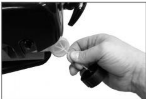
Рис. 14 Снятие крышки топливного бака
