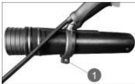
Рис. 4 Установка рукоятки управления 1. Винт хомута крепления рукоятки управления
