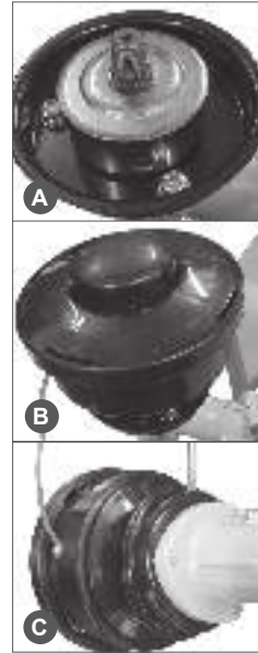
Рис. 6 Установка триммерной головки
