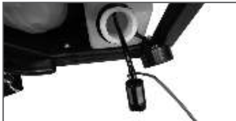
Рис. 22 Извлечение топливного фильтра
