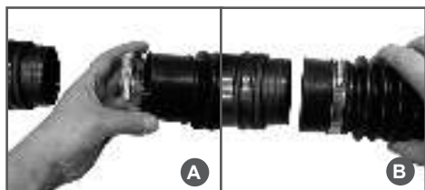
Рис. 3 Установка гибкой трубы
