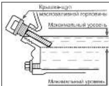
Рис. 8 Проверка уровня масла в картере
