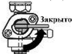
Рис. 7 Топливный кран закрыт
