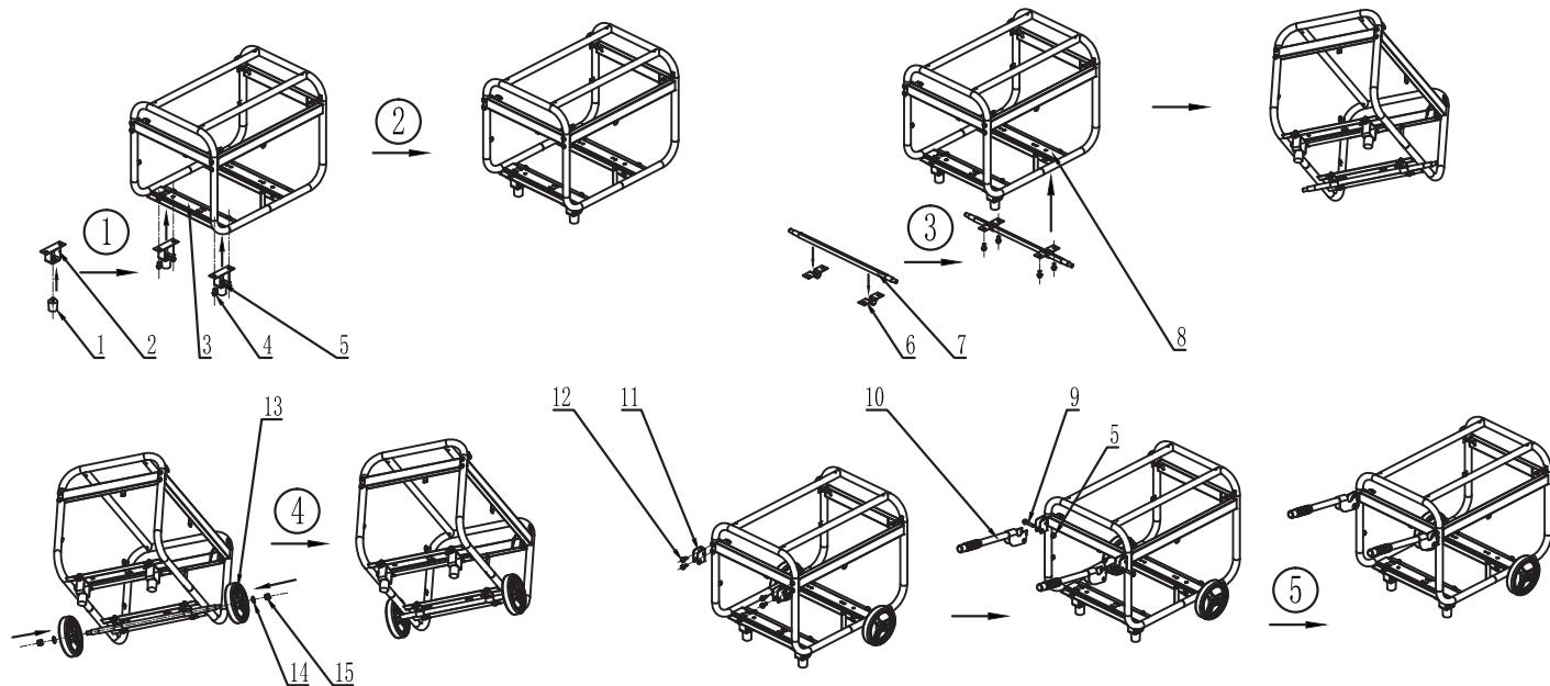
**УСТАНОВКА ТРАНСПОРТИРОВОЧНОГО КОМПЛЕКТА****Установка транспортировочного комплекта SRGE 3800 и SRGE 3800E**
