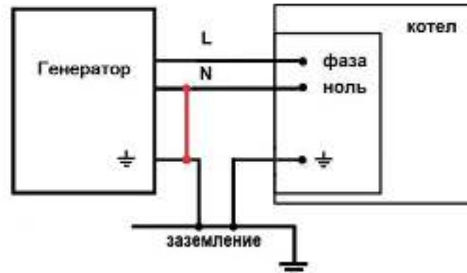
**ВНИМАНИЕ!** Использование генераторной установки с «заземлением» без заземления корпуса небезопасно.
