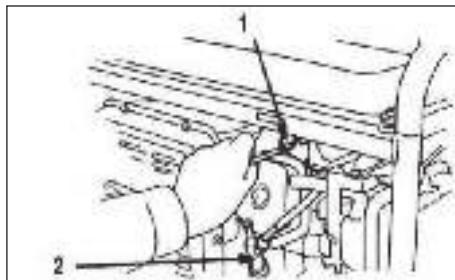
**СВЕЧА ЗАЖИГАНИЯ****Замена/очистка свечи зажигания**
