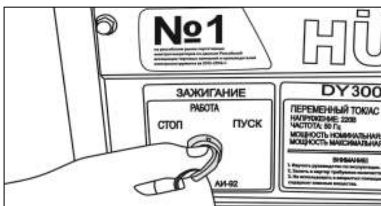
Рис. 17. Запуск двигателя электростартером
